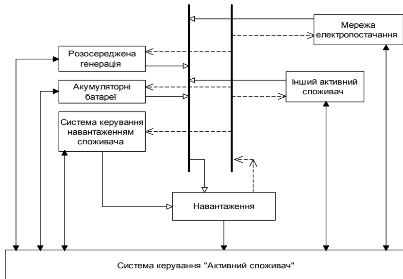
Рис. 3.11. Зв'язок між обладнанням активного споживача та іншими елементами електроенергетичної системи
