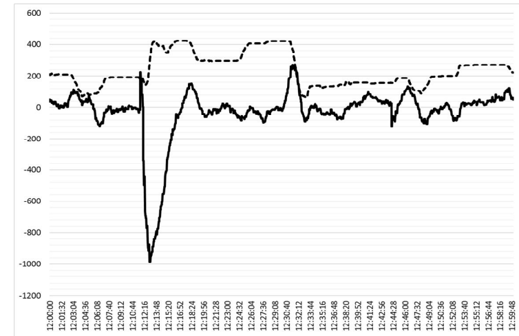
Рис. 4.3. Помилка регулювання області (суцільна лінія) та потужність генерації регулюючої Дніпровської ГЕС-1 (пунктирна лінія) у разі відключення енергоблока АЕС
