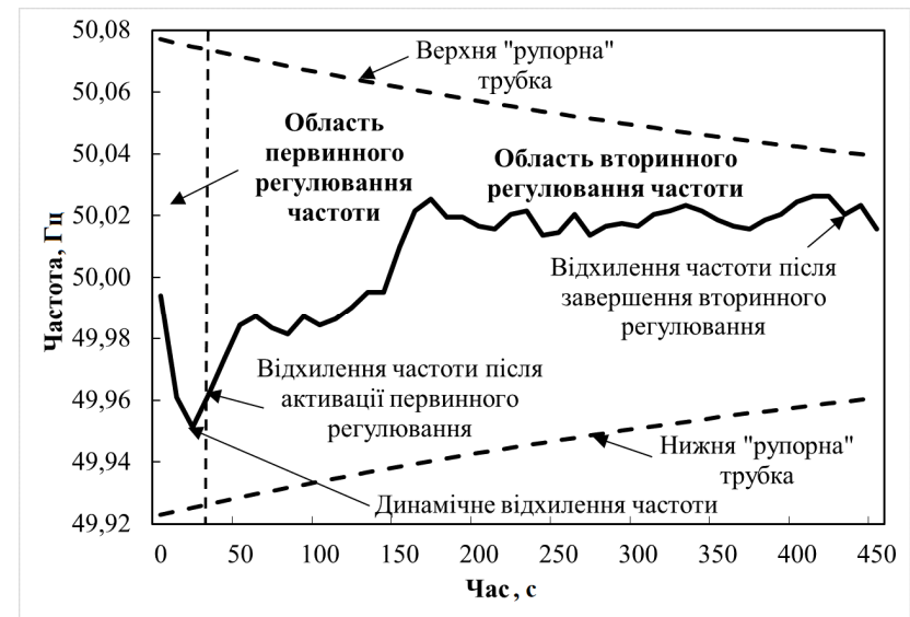
Рис. 4.1. Зміна частоти в ОЕС України (відповідно до даних моніторингу системи SCADA/AGC)
