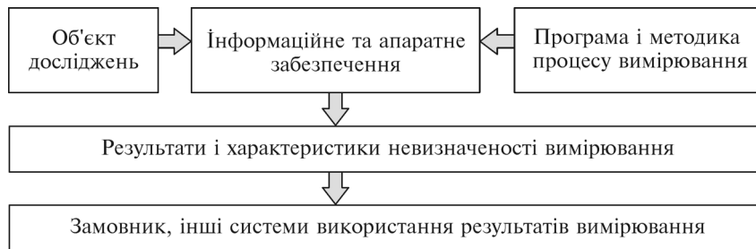
Рис. 1.5. Структурна схема завершального етапу процесу вимірювання
