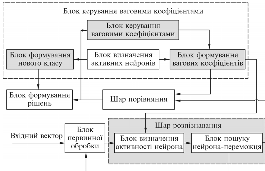
Рис. 6.9. Структурна схема модифікованої нейронної мережі ART-2
