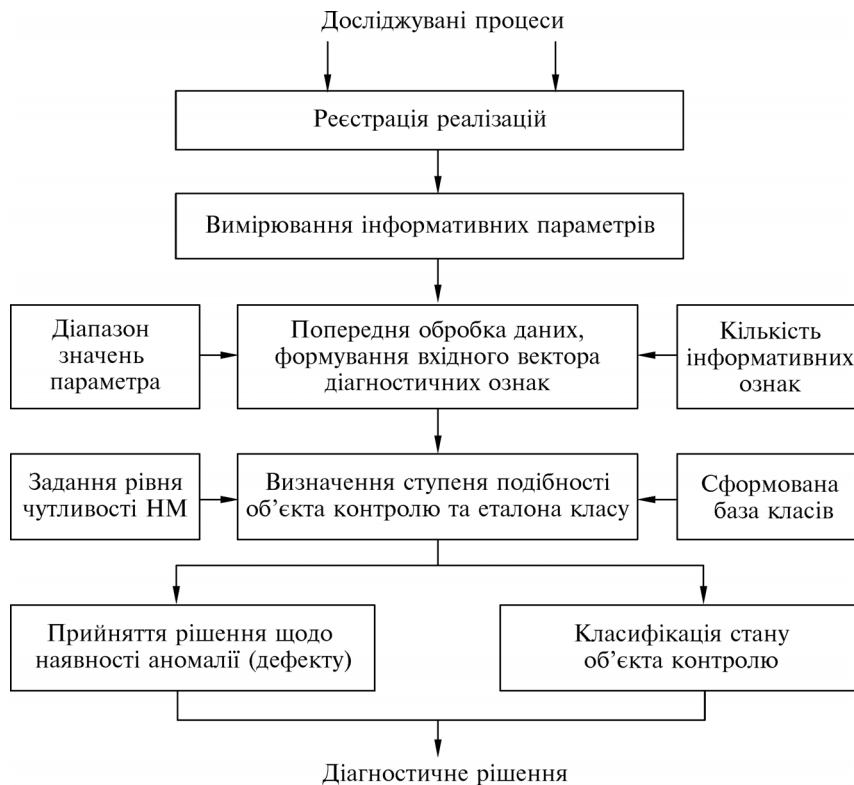
Рис. 6.6. Структурна схема блока діагностики
