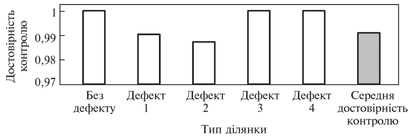
Рис. 6.13. Достовірність контролю з використанням класифікатора на базі мережі ART-2
