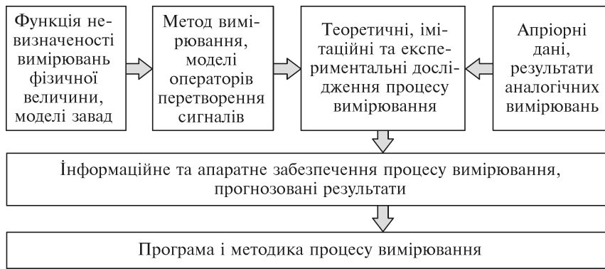
Рис. 1.4. Структурна схема проведення етапу створення інформаційного та апаратного забезпечення процесу вимірювання
